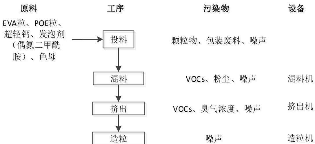
图 2-3 项目 EVA 造粒生产工艺流程图
