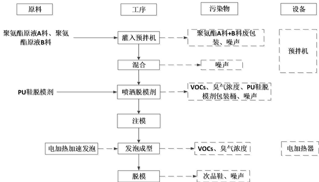
图 2-5 PU 鞋生产工艺流程图
