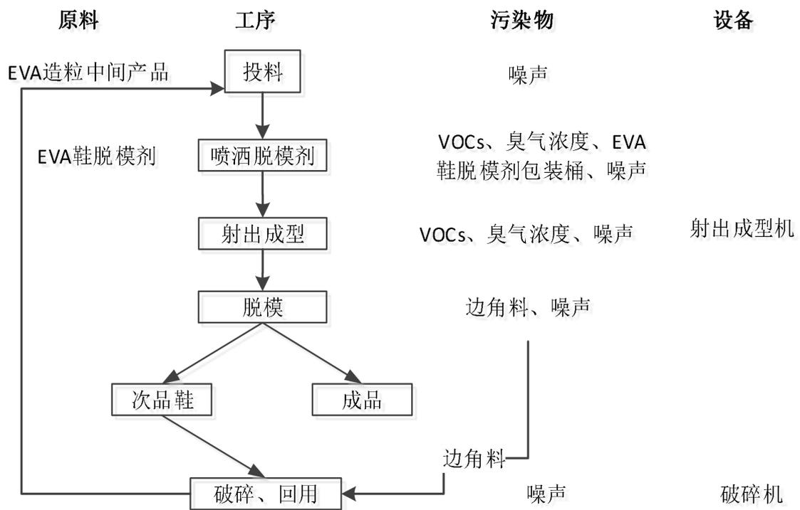
图 2-4 EVA 鞋生产工艺流程图
