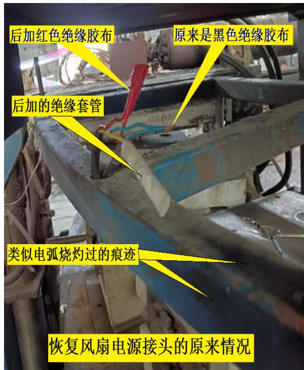
图 4 风扇电源线接头的位置情况图 图 5 恢复风扇电源接头原状图
