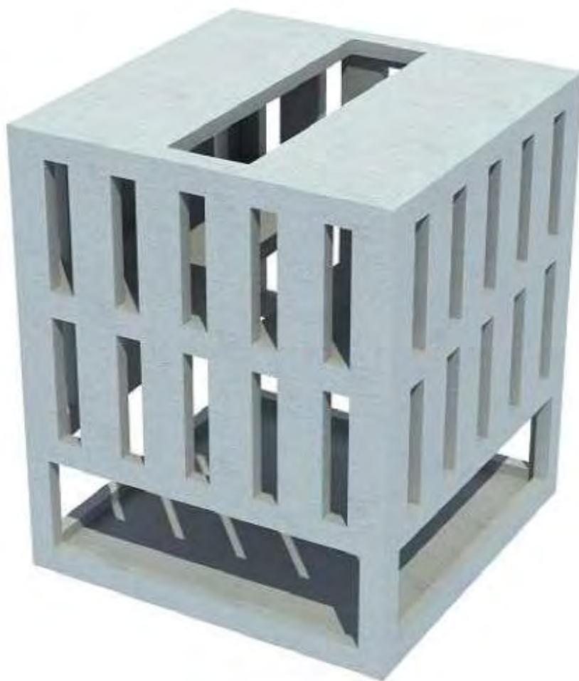
图 2-3 长方体框架钢混多功能饵料礁
