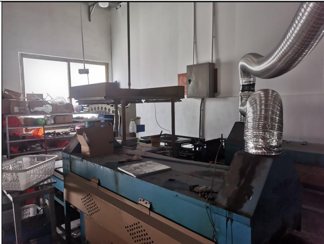
图 2-10 本项目滴塑机及配套烤箱图片
