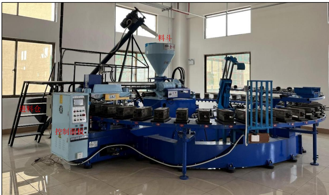
图 2-8 本项目大型圆盘注塑机图片
