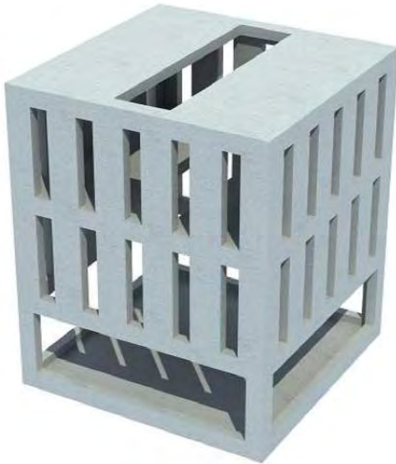
图 2-3 长方体框架钢混多功能饵料礁
